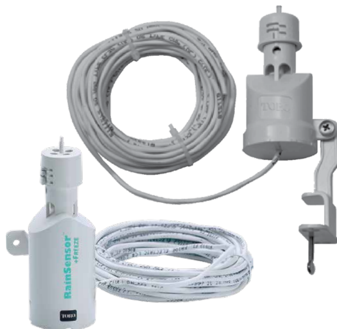
Kabelový senzor deště/mrazu Nový kabelový senzor deště/mrazu automaticky pozastaví zavlažování, pokud teplota klesne pod 2,8 °C. Šetří tím potrubní síť a zavlažovací komponenty.
