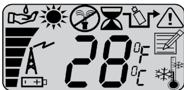
První displej LCD bezdrátového dešťového senzoru Poskytuje informativní systémové údaje, například o venkovní teplotě, síle signálu vysílače či stavu baterie.
